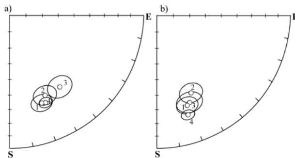
Figura 6. Comparación de las medias de las zonas estudiadas *in situ* (a) y realizando corrección estructural (b). 1) Combinado Panalillo-Graben de Bledos 2) NW o La Pendencia, 3) Centro norte o Ahualulco-Mexquitic, 4) Norte o Valle Umbroso.
